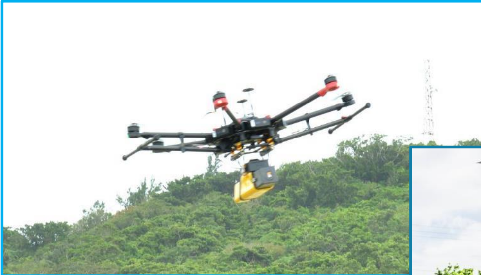
UAVレーザーYellowScan搭載状況
