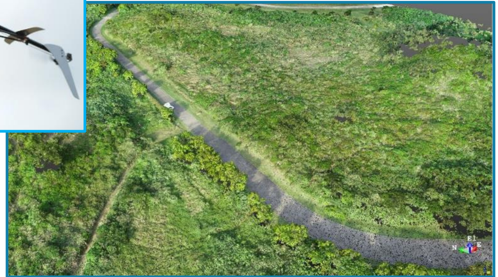
点群処理ソフトによる三次元点群データの生成
