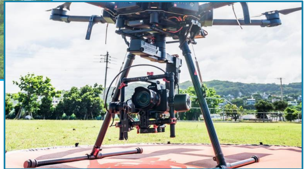
高解像度カメラSONY α7R II 搭載状況
