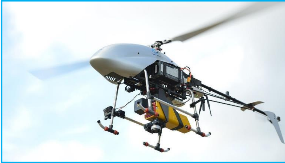
UAV搭載型レーザー scanner による計測状況
