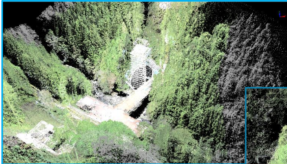
UAVレーザーによる全体点群データ
